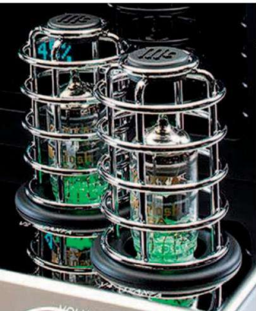
HEIMELIG: Die pro Kanal zwei Doppeltrioden 12AX7a der Vorstufe schützen kleine Rundkäfige. Von unten hüllen sie grüne Leuchtdioden in wohllig-smaragdnen Schimmer.
